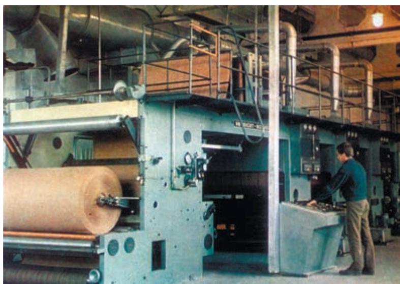
*Печатная машина нанесения на бумагу рисунка, имеющего текстуру древесины. Ширина бумажного полотна — 1900 мм*
